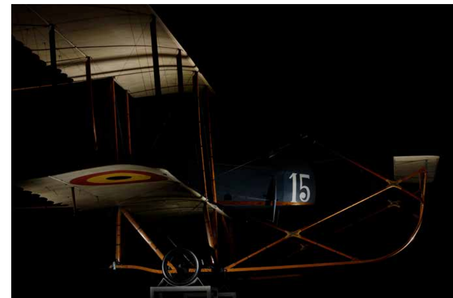
Avion Maurice Farman MF.7 Constructeur : Farman, France, 1913 Bois, toile enduite et peinte, métal Entoilage et peinture refaits. Inv. 26
