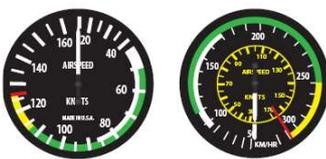
La vitesse peut être indiquée en nœuds (compteur **a**) ou en km/h (compteur **b**). Les couleurs aident le pilote à respecter les configurations de vol : utilisation des volets (zone blanche), vitesse de croisière (zone verte), zone de prudence (jaune) et vitesse limite (trait rouge).
