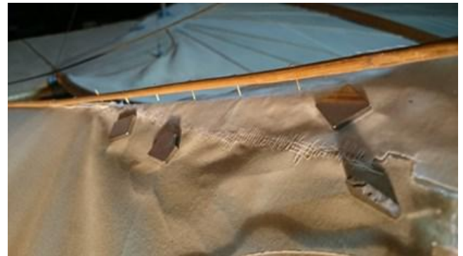
Collage fil à fil d'une pièce de toile au cours de la restauration du Lillienthal modèle 1895.
